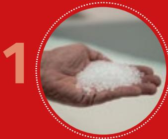
1 Como matéria-prima o polipropileno, polímero termoplástico produzido a partir da polimerização do gás propileno ou propeno, derivado do petróleo, o material é combinado à coloração desejada e submetido a temperatura elevada.
